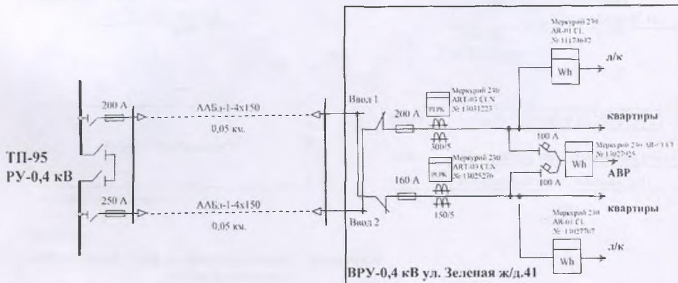
Примечание: В схеме указываются номера счетчиков, параметры измерительных трансформаторов тока и напряжения, границы балансовой принадлежности (красный цвет) и эксплуатационной ответственности (синий цвет).
